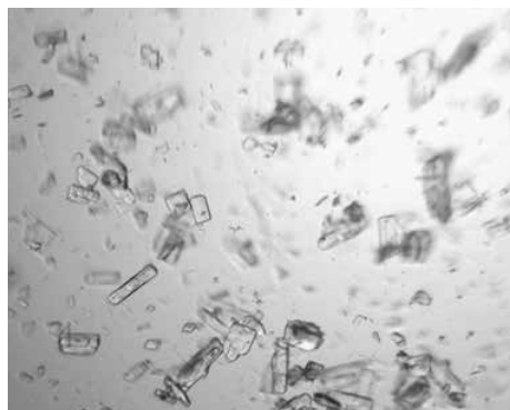
Рис. 1. Мікрофотознімок порошку амлодипіну бесилату виробника «Anek Prayog Pvt. Ltd», Індія. Збільшення: об'єктив 10x
