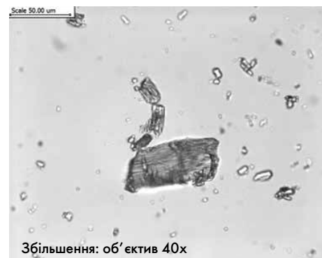
Рис. 2. Мікрофотознімок порошку валсартану виробника «Zhejiang Huahai Pharmaceutical Co., Ltd», Китай
